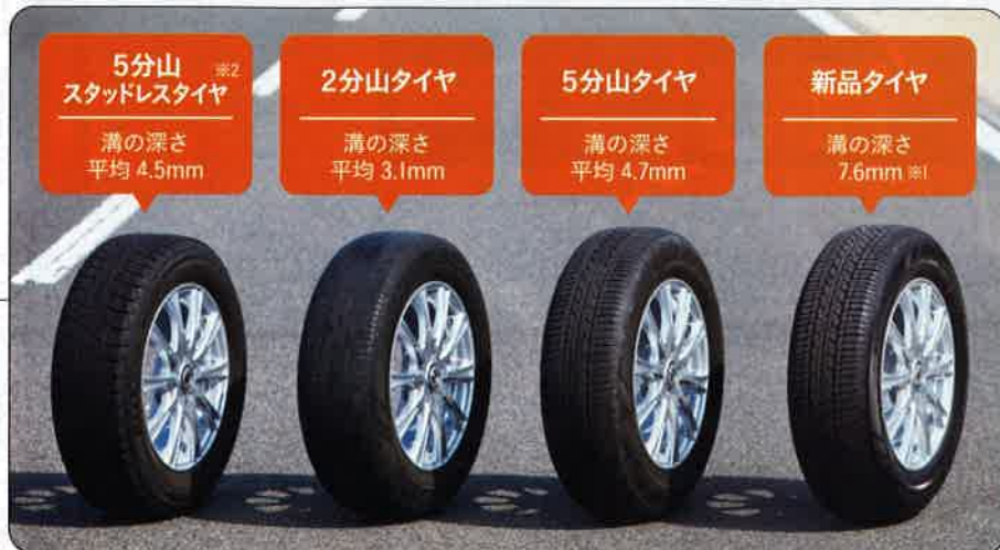
※1 溝の深さはタイヤの接地面中央で計測。タイヤの山は新品の溝の深さから使用限度1.6mmを引いた数値を10分山として計算。 ※2 冬タイヤの使用限度を示すプラットホームが出たタイヤ。夏タイヤとして使用可能(右下コラム参照)。
